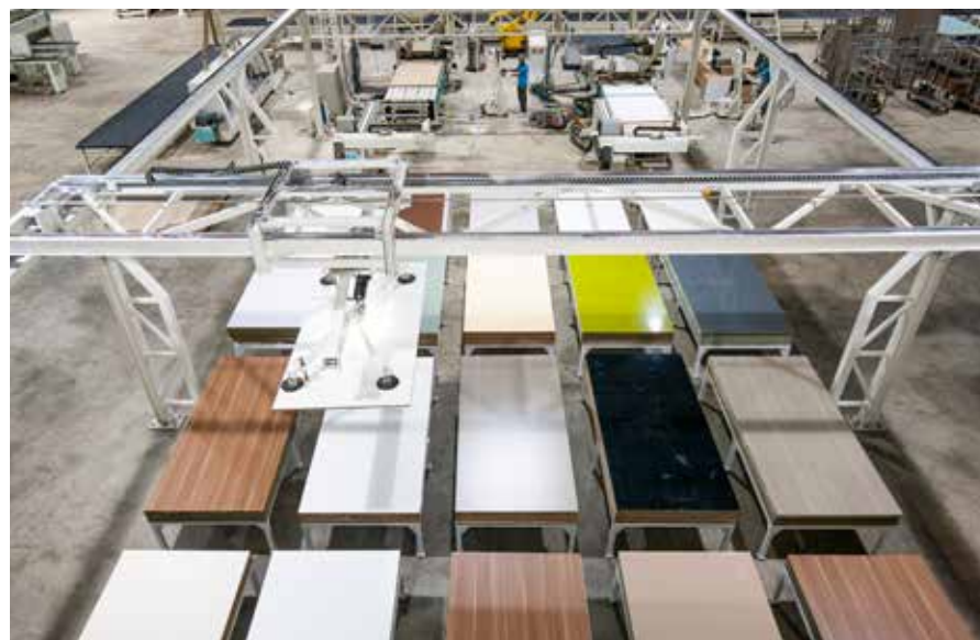
Hệ thống kho thông minh - nạp liệu tự động
