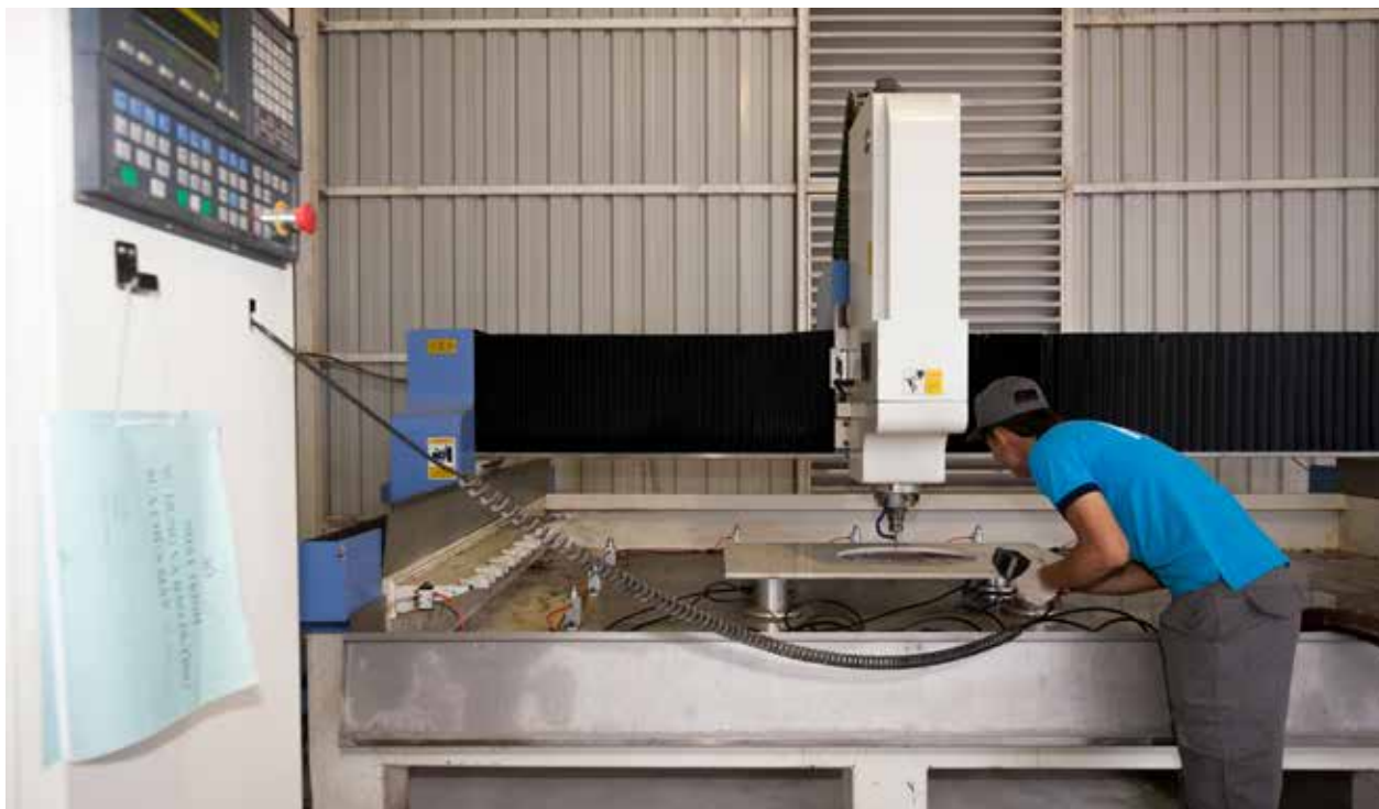
Máy phay hoàn thiện cạnh đá CNC 3 trục
